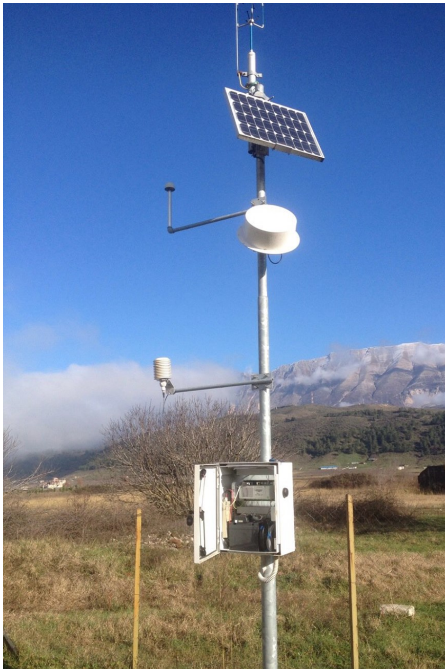
Автоматична метеостанция, част от националната система за мониторинг
